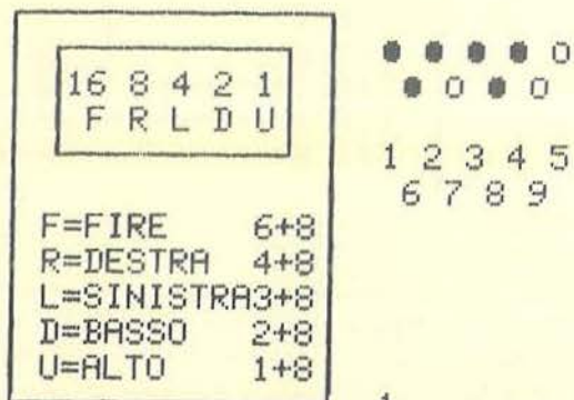
Figura 1. Tabella dei bit relativi agli interruttori del joystick e dei pin usati da questi interruttori.
